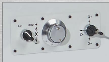
Un joystick ainsi que 2 manivelles électroniques disponibles en face avant du carter permettent d'effectuer aisément les opérations de réglage et de rectification manuelle.
