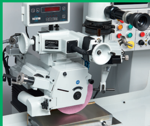
▲ Dispositif de profilage de meule "OPTIDRESS"
