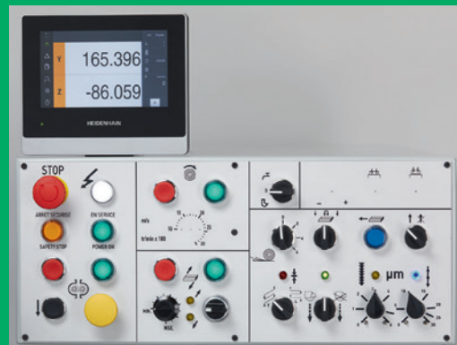
▲ Pupitre de commande avec plongée cyclée et visualisations numériques au micron
