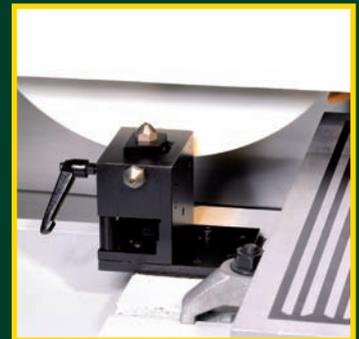
**Abrichten automatisch der Schleifscheibe in Zyklus mit Ausgleich.**
